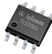
TLE5501 は、磁場配向を検出する 360° TMR ベースの角度センサです。TMR (トンネル磁気抵抗)素子で sin および cos の角度成分を計測することで行います。これらの RAW 信号 (sin, cos)は、差動出力信号として供給され、マイコン内で直接処理されます。ブリッジの大出力電圧は、信号増幅を不要にします。
