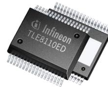
スマートパワーテクノロジーによる 10 チャンネル ローサイドスイッチで、シリアルペリフェラルインターフェイスおよび 10 個のオープンドレイン DMOS 出力段を備えています。TLE8110ED は、組み込み保護機能によって保護されており、車載および産業用アプリケーション向けに設計されています。出力段は PWM 用途向けの平行入力ピン、または SPI インターフェイスを介して制御されます。TLE8110ED は、エンジン制御およびパワートレインシステムに特に適しています。
