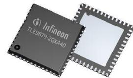
TLE9879-2QXA40 は、ARM® Cortex™ M3 コアを搭載したシングルチップ 3 相モータドライバで、磁界方向制御などの高度なモータ制御アルゴリズムの実装が可能です。本製品は、完全に統合された NFET ドライバを 6 個搭載しており、3 相モータを 6 個の外部パワー NFET から駆動できるように最適化されています。また、充電ポンプにより低電圧動作が可能です。プログラマブル電流は、電流スロープ制御とともに、EMC 性能を最適化します。
