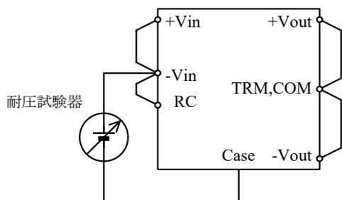
図6-13 入力-ケース間耐電圧試験方法
