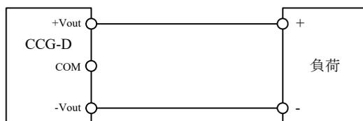
図6-11 CCG-D単出力で使用する場合の接続
