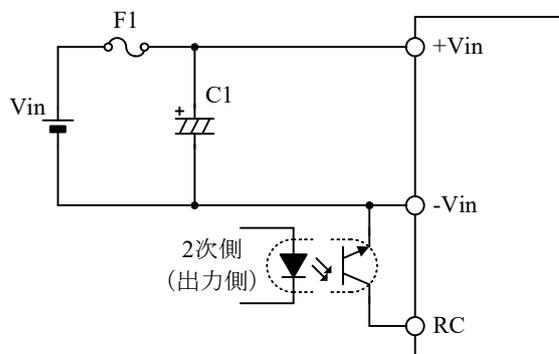
図6-6 RC端子接続例 (2)
