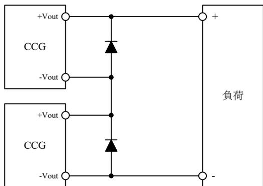
図6-9 出力電圧積み重ね直列運転
