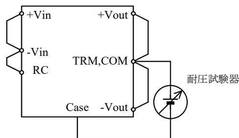
図6-14 出力-ケース間耐電圧試験方法
