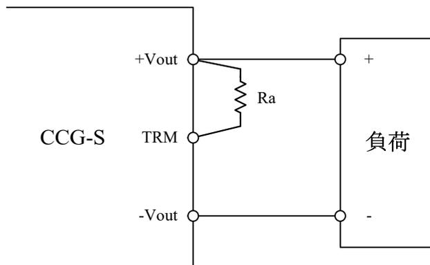
図6-2 出力電圧を低く設定する場合の基本的な接続
