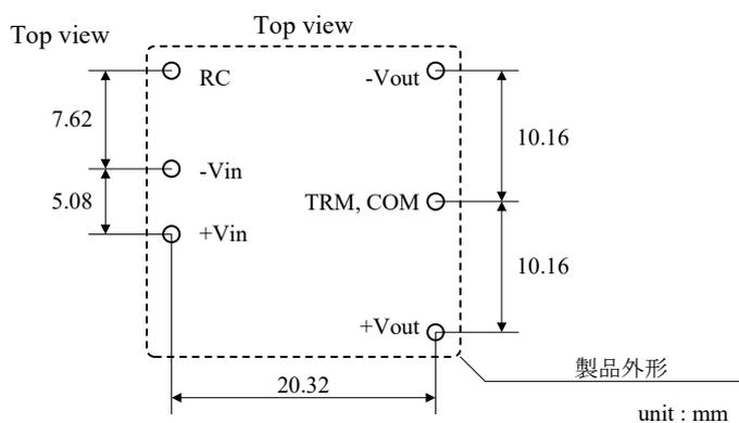
図8-1 基板取付け穴寸法図
