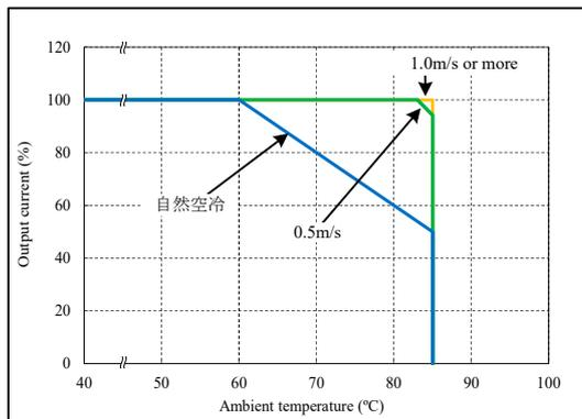
◆CCG30-24-12S, CCG30-24-15S, CCG30-48-15S, CCG30-24-15D, CCG30-48-15D (共通)
