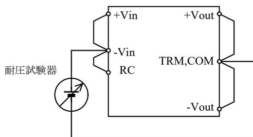
図6-12 入力-出力間耐電圧試験方法
