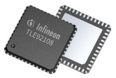
バは、その外付けMOSFETのドレイン・ソース間電圧を監視してハード短絡状態を検出します。また、内蔵の電流検出アンプに流れる電流を監視して、設定可能なソフト短絡検出を行うことができます。いずれの場合も、ソフトウェア手段に依存しないアクティブラッチ付きハードウェア保護を提供しています。
